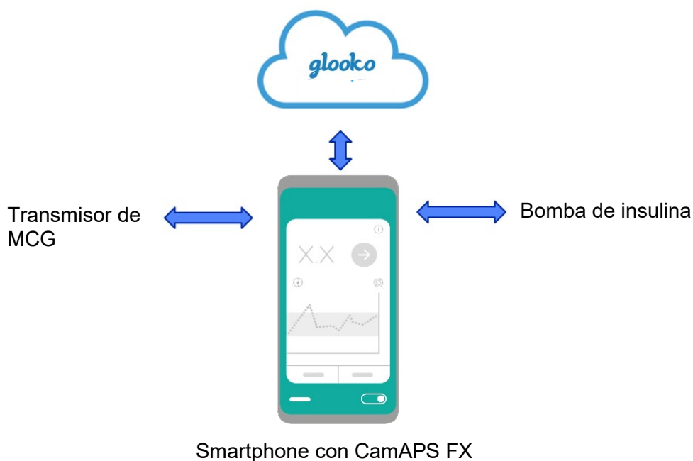
Figura 2: Ejemplo de configuración del sistema de Loop cerrado (automático) con la app CamAPS FX en el smartphone.
