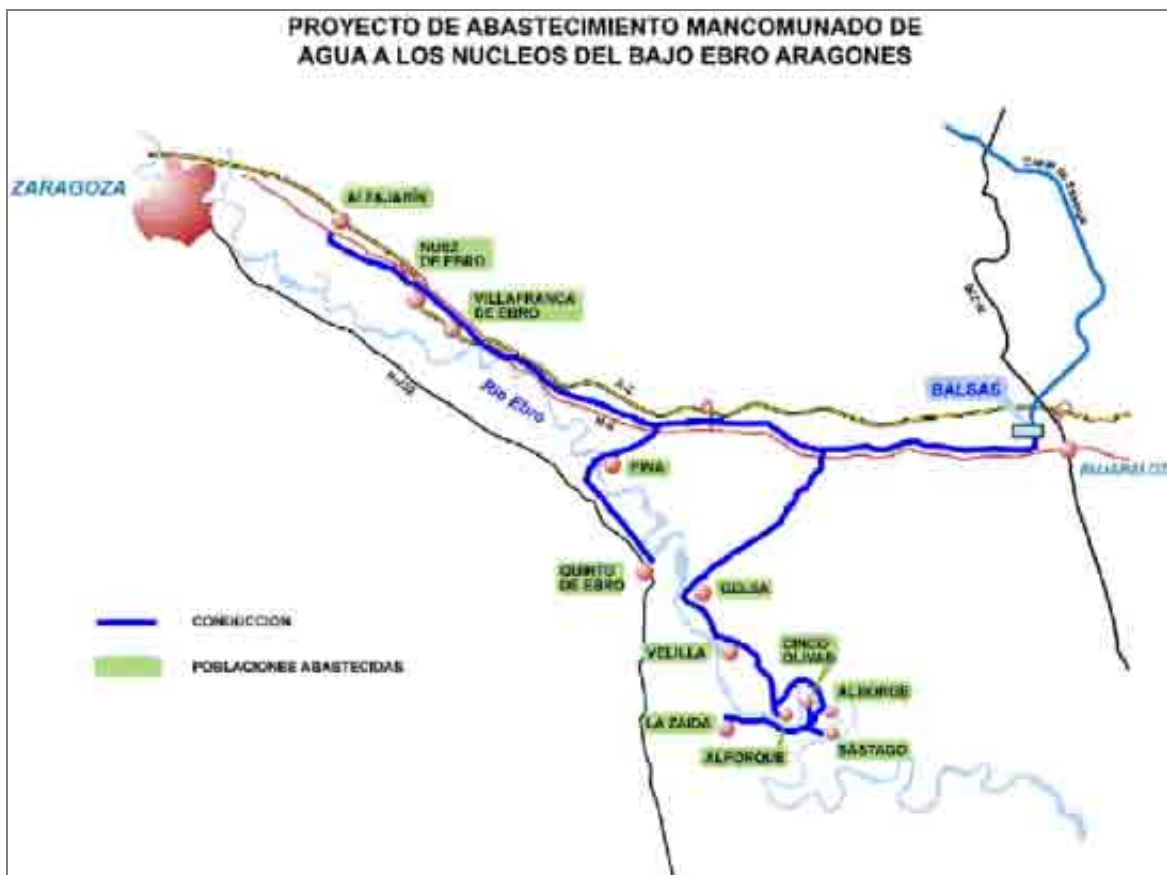
Figura 2.57: Esquema general del proyecto de abastecimiento mancomunado de agua a los núcleos del bajo Ebro Aragonés (Fte. ACESA)
