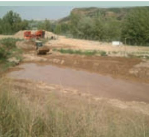
Balsa de lodos. Los sólidos se depositan y las aguas claras retornan al circuito de lavado de arenas. El lodo seco se retira con pala cargadora y se lleva, en camiones, a las áreas a restaurar
