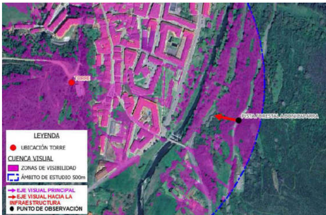
Análisis de los puntos de observación sensibles. Carretera LR-111 – Evaluación de la visibilidad de la infraestructura
