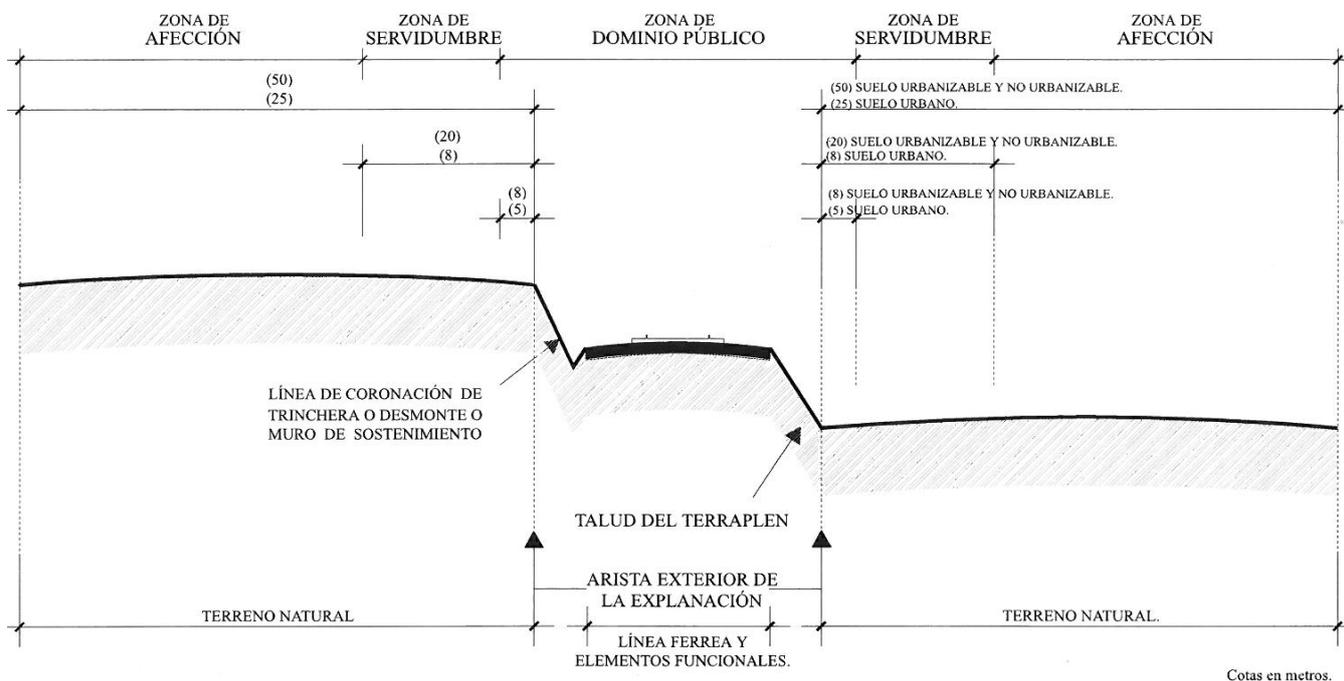
EXPLANACIÓN: Franja de terreno en la que se ha modificado la topografía natural del suelo y sobre la que se construye la línea férrea, se disponen sus elementos funcionales y se ubican sus instalaciones.
