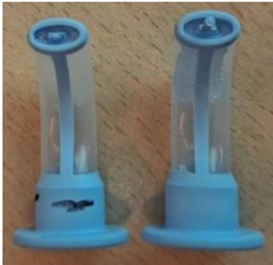
Ejemplo del defecto de fabricación observado en las Cánulas Guedel
