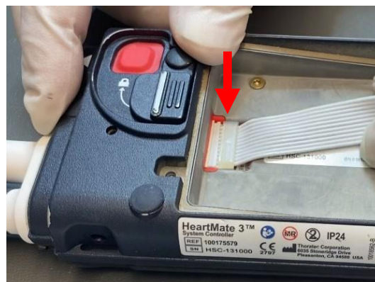
Figura 1: Conexión del cable de cinta de la batería de respaldo
