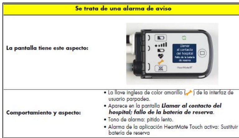
Figura 2: Alarma de fallo de la batería de respaldo, en pág. 7-24 del manual de Instrucciones de uso del médico de LVAS HeartMate 3™
