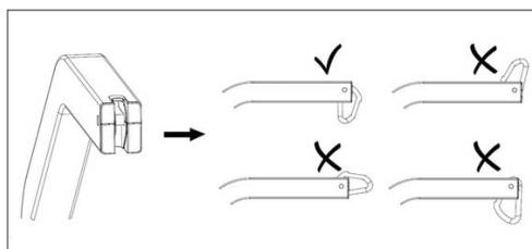
Detalle con la posición correcta(arriba) e incorrecta (abajo) del mosquetón en el brazo de la grúa
