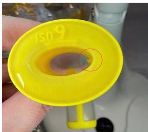
Ejemplo del defecto de fabricación de las Cánulas Guedel
