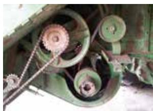
**Limpiar** los mecanismos internos (rodamientos, correas...); limpiar las acumulaciones de polvo/paja, etc. del interior y alrededores del motor dos veces al día para evitar igniciones por fricción (cambio cada 2-3 años).
