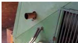
Mantener el **tubo de escape con matachispas** instalado y en buen estado.
