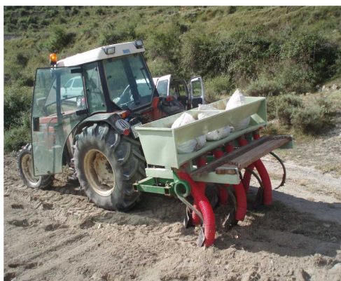
Sembradora de patatas adaptada para la plantación de bulbos de azafrán en Munilla
