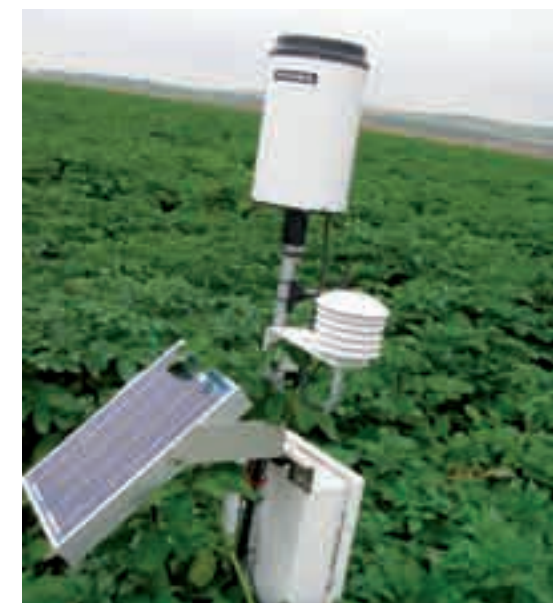
Estación agrometeorológica en una parcela de control de mildiu en Bañares.
