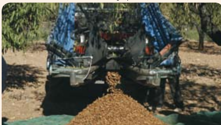
Paraguas para la recolección mecanizada de almendro.
