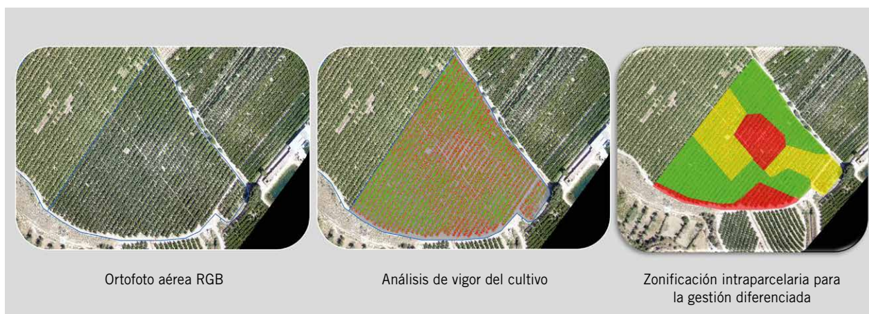
Figura 1. Imágenes de dron para la zonificación de una parcela. / Drónica
