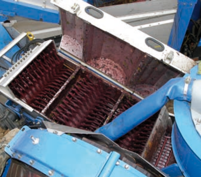
La despalilladora permite eliminar la mayor parte de las impurezas.
