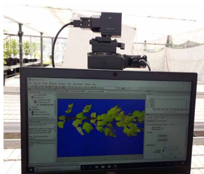
Empleo de imágenes multispectrales para la detección de enfermedades en las instalaciones de AGACAL en Ribadumia (Galicia). / AIMEN y AGACAL
