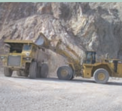
Carga en el frente con pala cargadora
