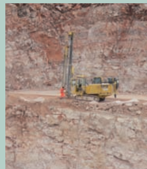
Perforación en el frente de cantera
