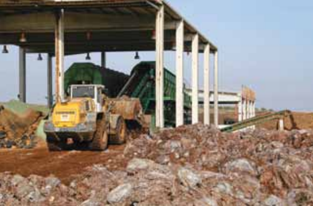
La pala incorpora al trommel los paquetes de champiñón donde se separa el plástico del sustrato.
