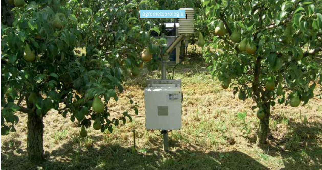
Estación meteorológica en una parcela de peral para aplicar un modelo de riesgo de mancha negra. / SIAR
