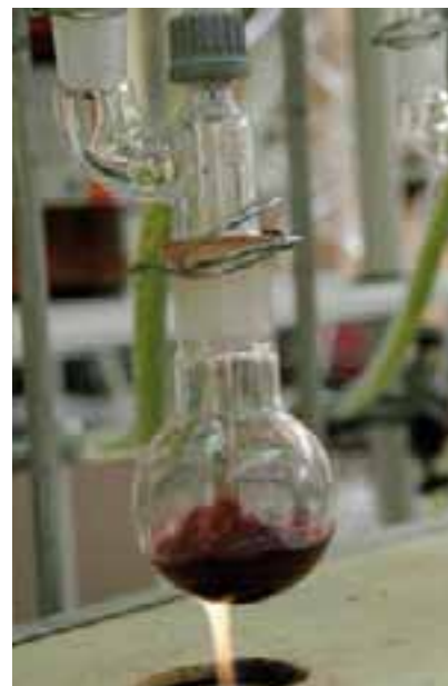
Matraz para determinar el sulfuroso del vino.
