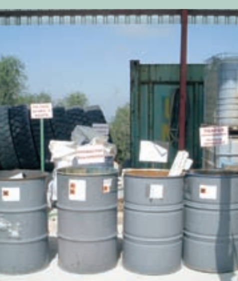
Punto limpio. Los diferentes depósitos tienen carteles indicadores del contenido, para una recogida selectiva de los residuos
