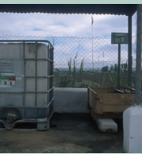
Depósitos para filtros de aceite y de hidrocarburos
