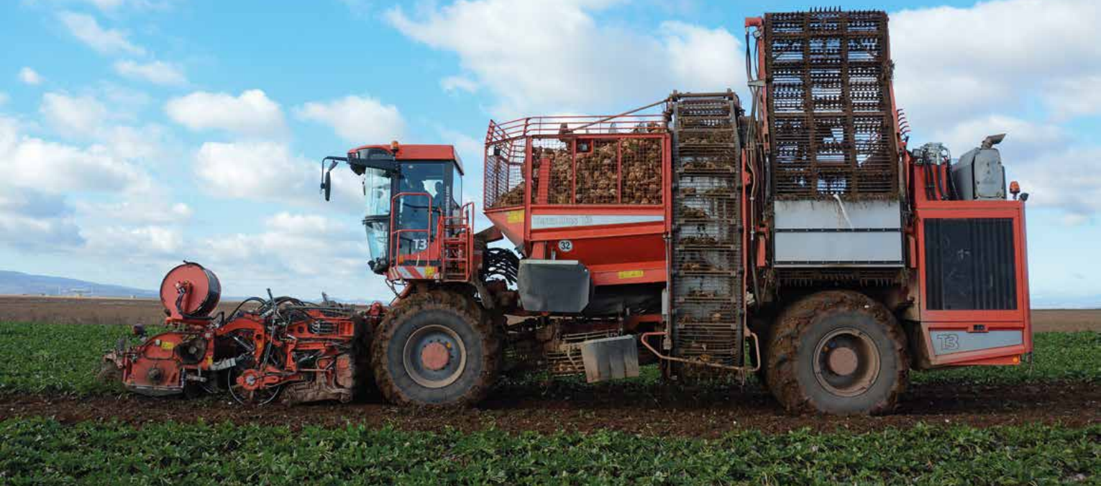
La cosechadora de seis surcos recoge una hectárea en dos horas.
