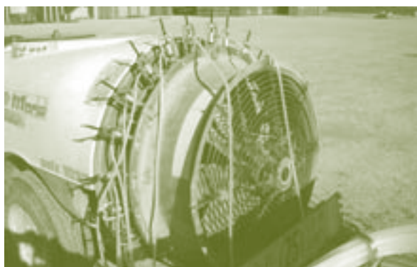
Caudalímetro con el que se comprueba el volumen de caudal en los atomizadores.
